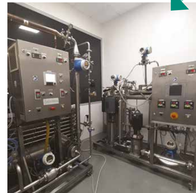
Instalacje badawcze MF/UF oraz NF/RO w laboratorium INTERMASZ – 2021
